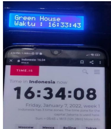
Gambar 8. Sinkronisasi waktu RTC dengan waktu internet.
