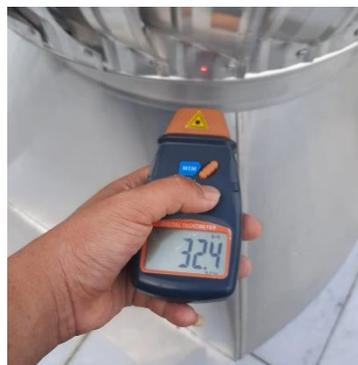
**Gambar 4.** Pengujian Kecepatan Turbin Di Luar Ruangan
