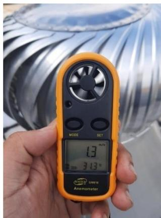
Gambar 2. Pengujian Kecepatan Angin
