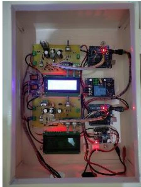
**Gambar 8.** Realisasi Perancangan *Buck-Boost Converter*
