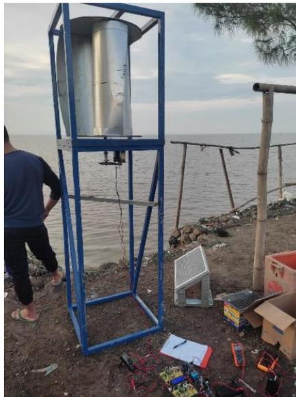
Gambar 5. Perancangan Mekanik Turbin Angin
