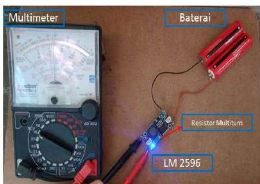
**Gambar 8.** Pengujian stepdown LM2596
