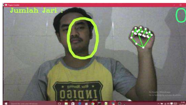
Gambar 5. Deteksi bentuk gestur jari angka 0 dengan keypoints menggunakan MediaPipe
