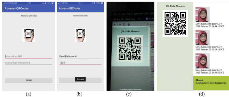
Fig. 3. (a) Login Interface. (b) Login successful interface (c) QR-Code Scanner (d) Web main interface
