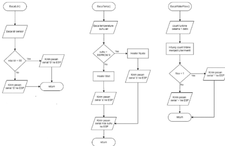
Gambar 6. Flowchart fungsi BacaLdr(), BacaTemp(), dan BacaWaterFlow()
